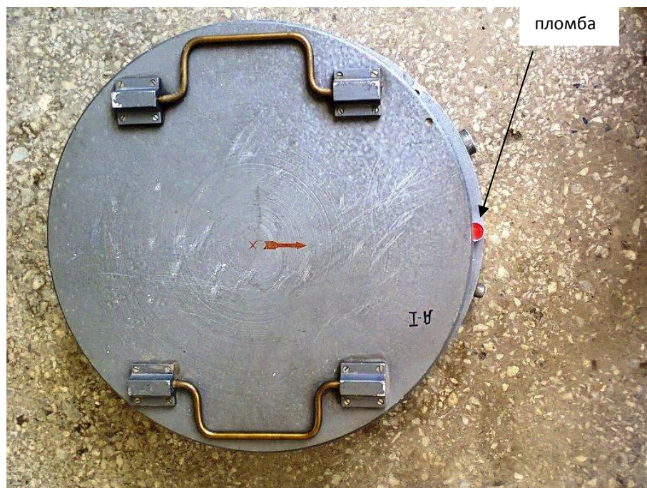
Рисунок 2 - Схема пломбировки от несанкционированного доступа СИАЗ-3
