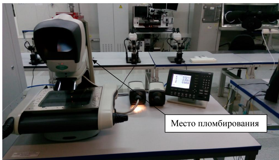
Рисунок 1 - Общий вид системы бесконтактных измерений HAWK/S/7
