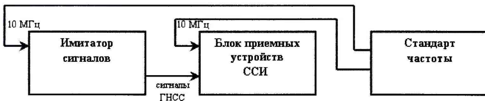
Рисунок 1 – Схема измерений для определения СКО случайной составляющей инструментальной погрешности измерений псевдодалности до навигационного космического аппарата
