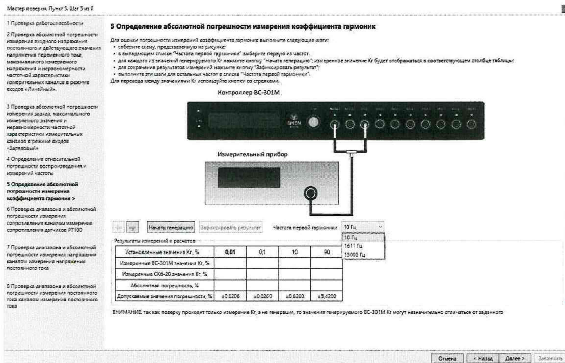
Рисунок 15 – Схема проверки погрешности измерений коэффициента гармоник
