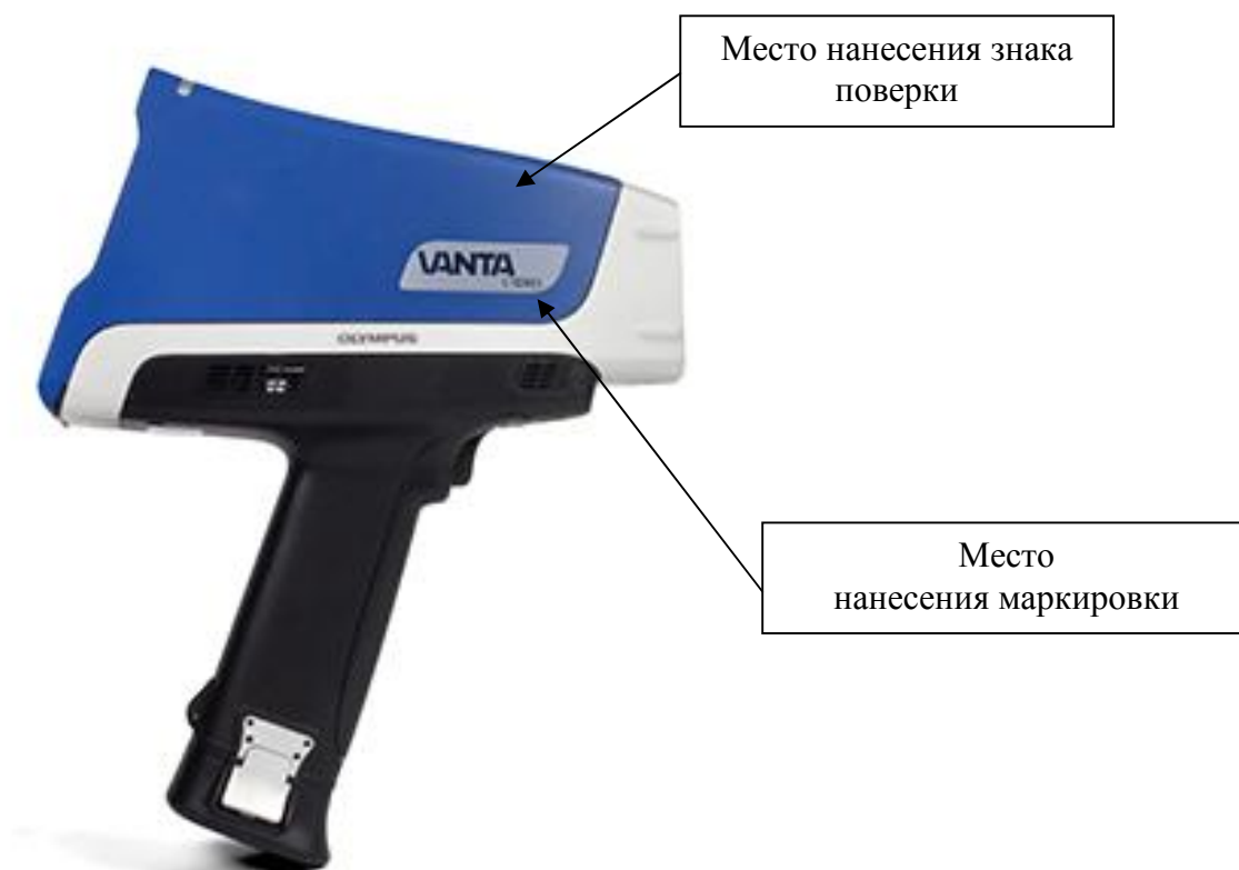
Рисунок 2 - Обозначение мест нанесения маркировки и знака поверки
