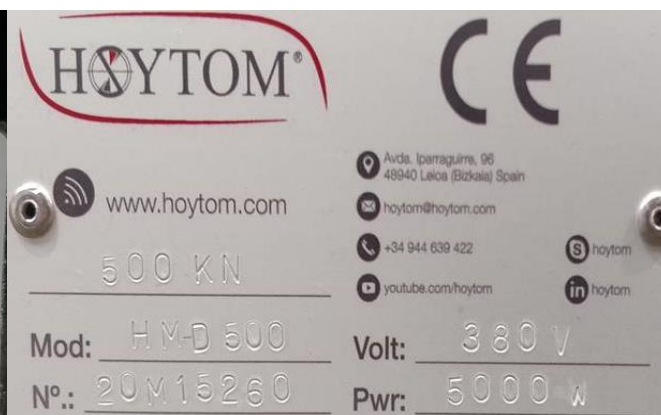
Рисунок 8 – Пример идентификационной таблички с заводским номером и место её нанесения
