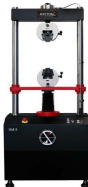
Рисунок 5 – Общий вид машин испытательных универсальных электромеханических модификаций HM-S 100, HM-S 150, HM-S 200, HM-S 250
