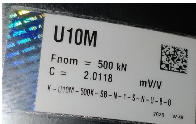
Рисунок 7 – Пример идентификационной таблички датчиков силы с наименованием модификации и место её нанесения
