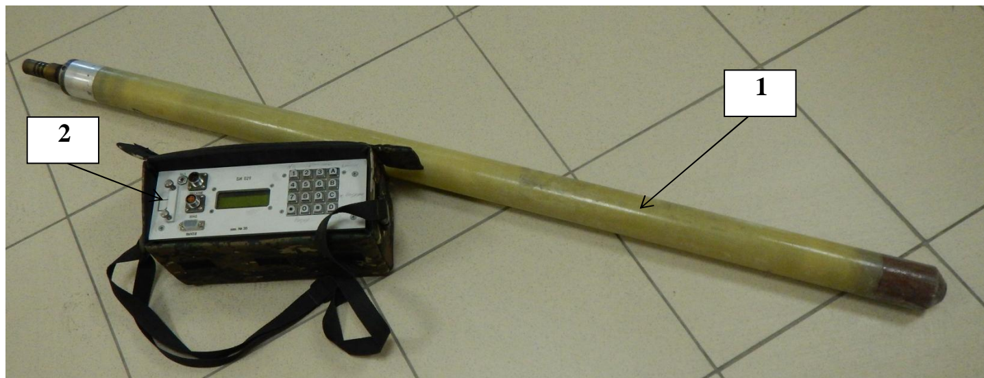
Рисунок 1 – Общий вид прибора в составе: 1 – скважинный зонд СП-1000, 2 – блок измерительный БИ-029.
