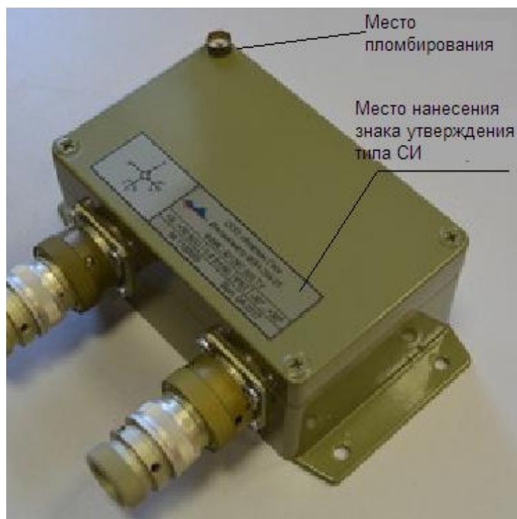
Рисунок 2 - Схема пломбировки от несанкционированного доступа и обозначение места нанесения знака утверждения типа СИ
