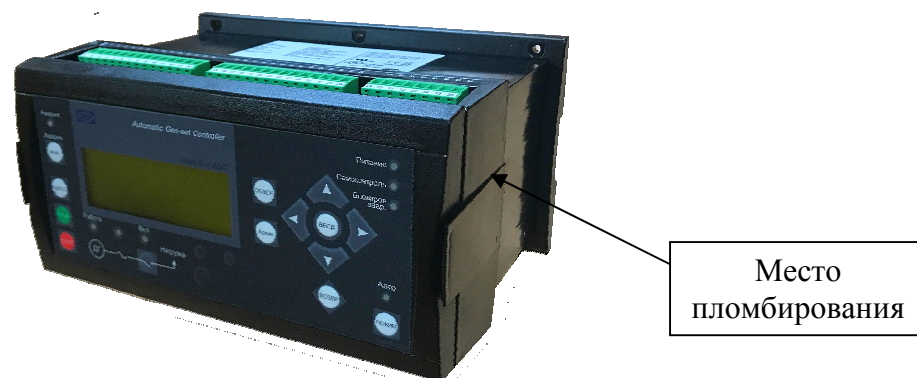
Рисунок 2 - Внешний вид контроллеров с установленной дисплейной панелью и место пломбирования от несанкционированного доступа
