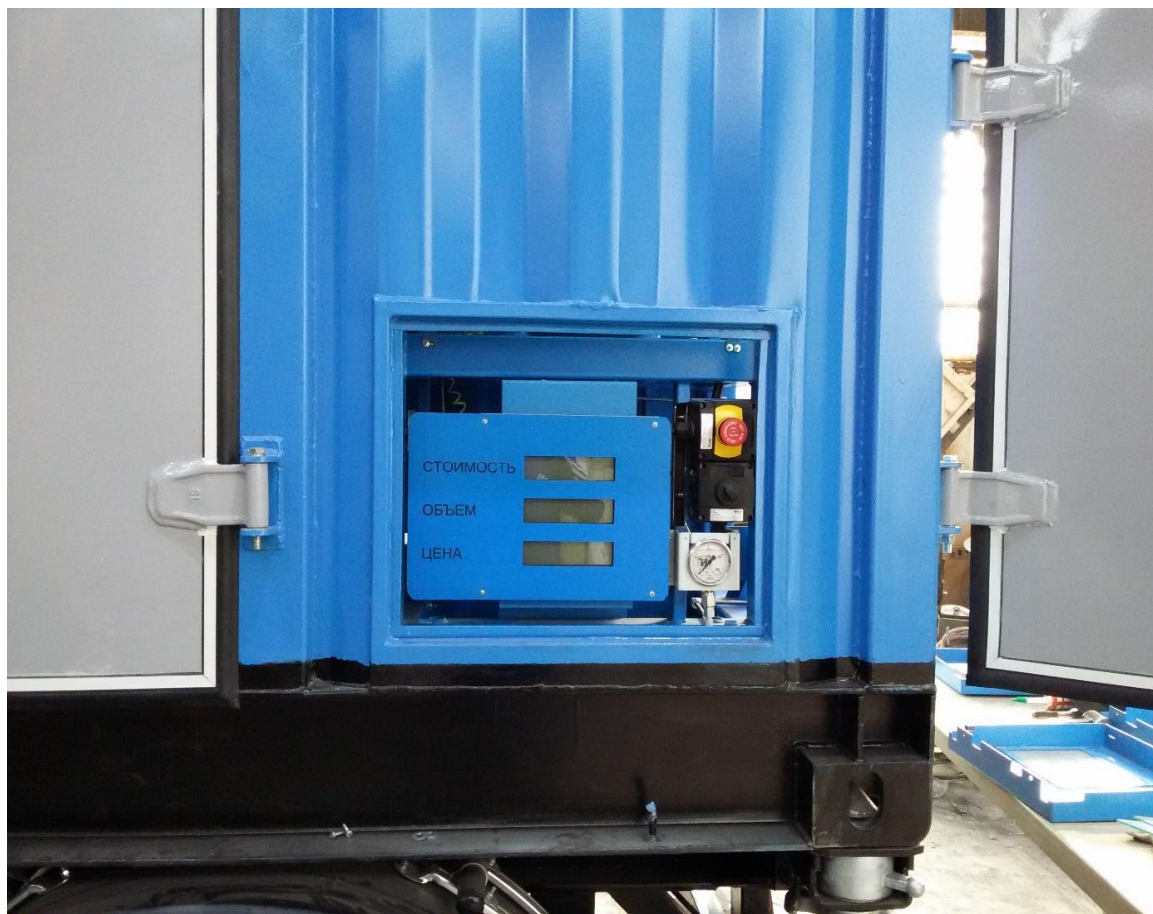
Рисунок 1- Вариант исполнения с расположением в составе передвижного автогазозаправщика
