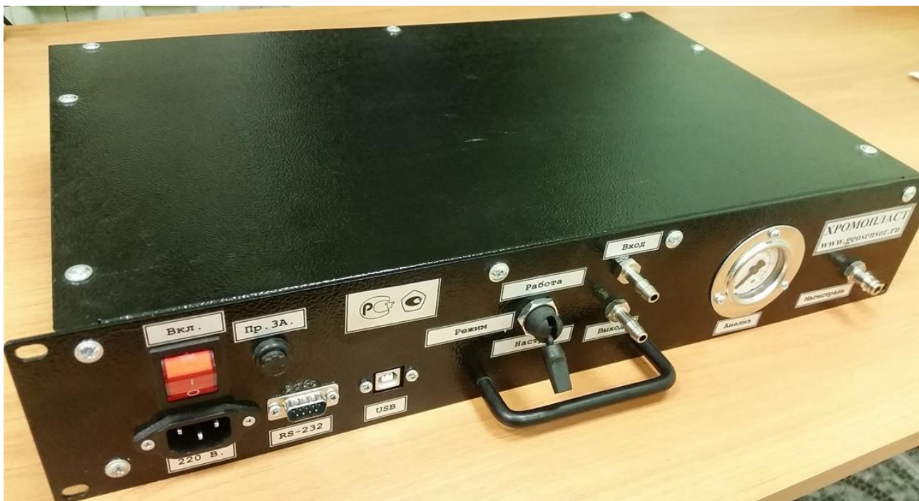
Рисунок 1 - Общий вид газоанализатора хроматографического Хромопласт
