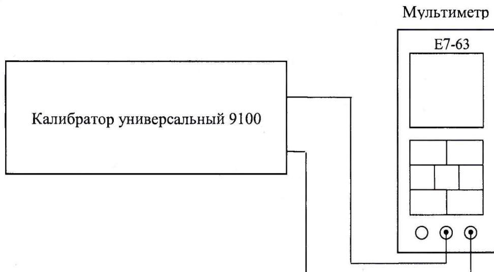
Рисунок 1 – Структурная схема опробования и определения погрешностей измерений напряжения и силы* постоянного тока, среднеквадратического значения напряжения переменного тока, электрического сопротивления постоянному току
