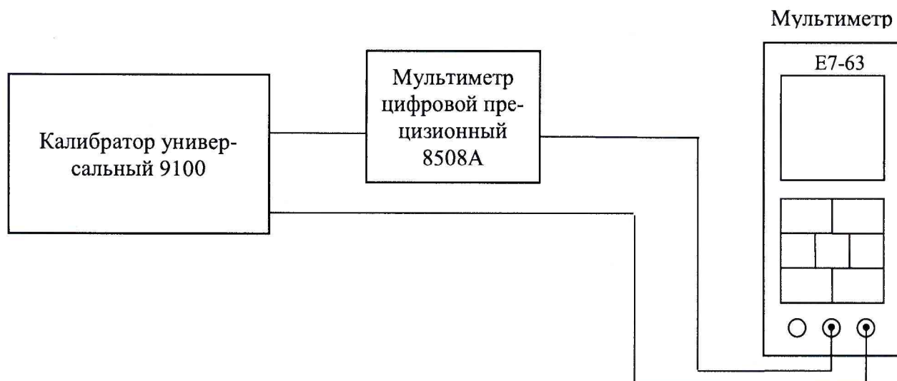
Рисунок 2 – Структурная схема опробования и определения приведенной (к верхнему значению диапазона измерений) погрешности измерений силы* переменного тока
