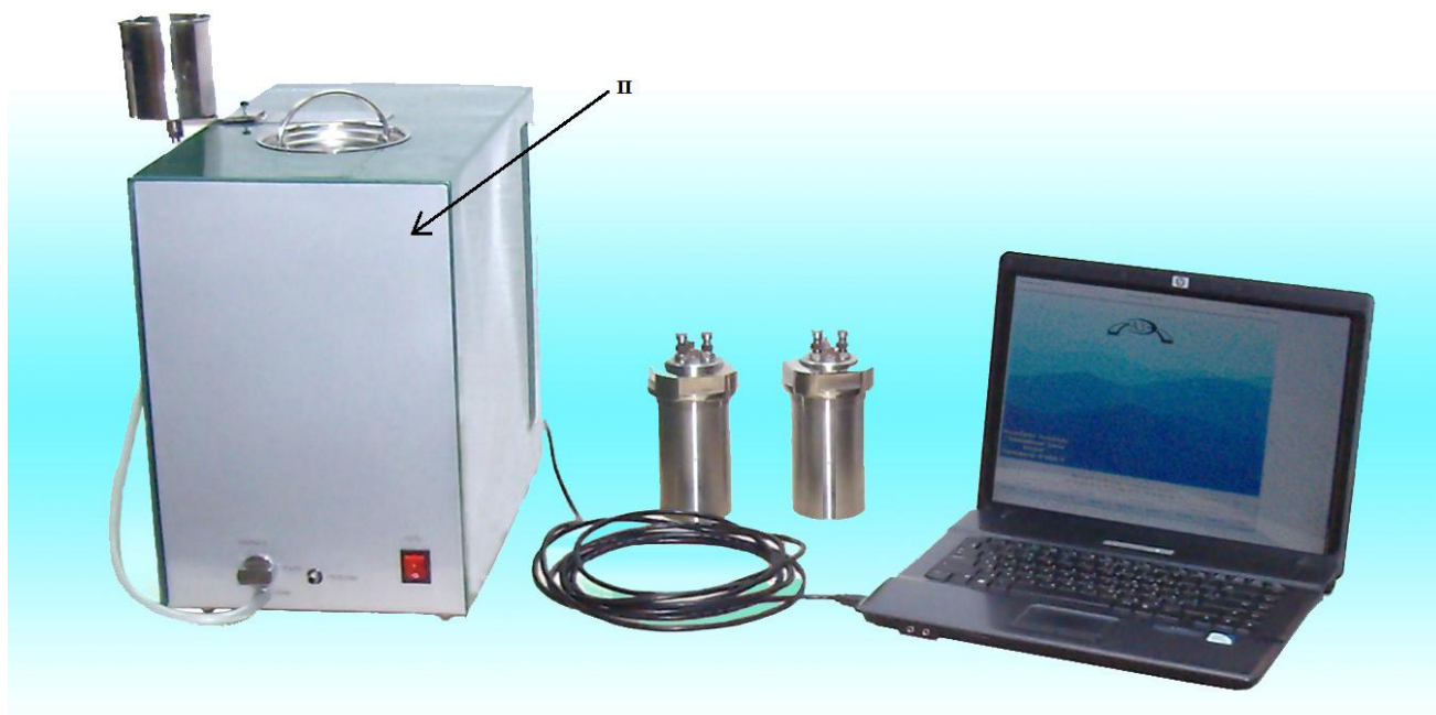
Рисунок 1 – Общий вид калориметра сжигания с бомбой (жидкостного) В-08МА «К»
