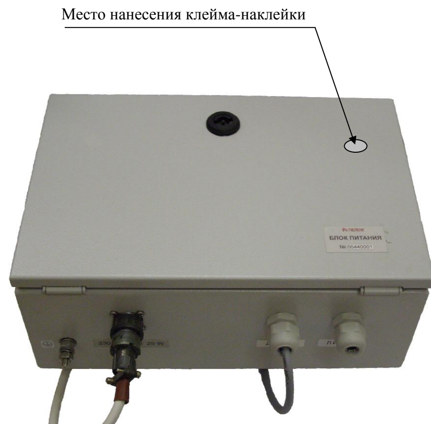
Рисунок 3 - Место нанесения знака поверки
