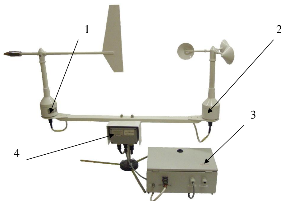
1 - румбометр, 2 - анемометр, 3 - блок питания, 4 - блок измерения
