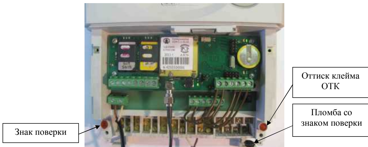
Рисунок 2 - Внешний вид отсека для установки дополнительных интерфейсных модулей
