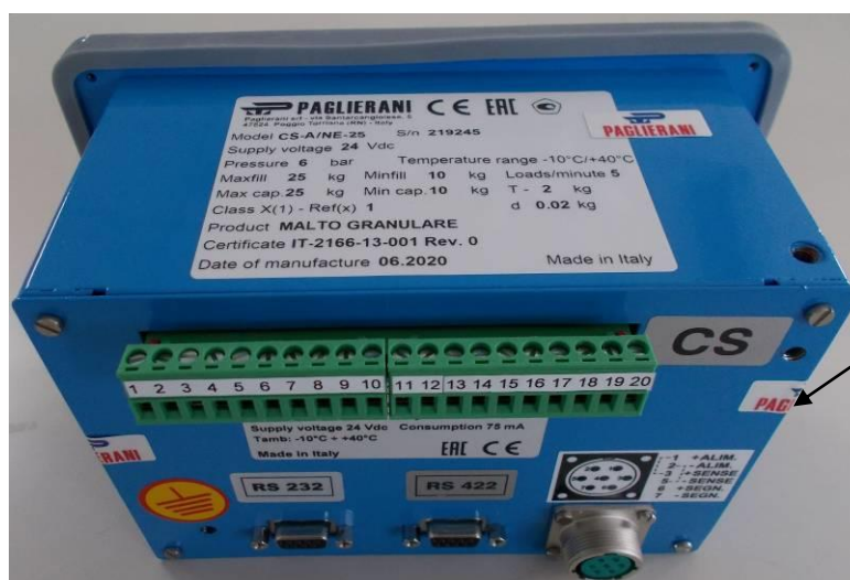
Рисунок 3 – Схема пломбировки индикатора от несанкционированного доступа
