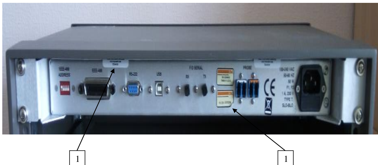
1 – место пломбировки от несанкционированного доступа 2 – место нанесения заводского номера Рисунок 4 – Внешний вид задней панели интерфейса FI7000
