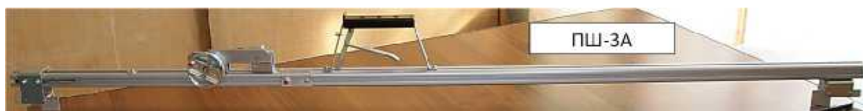
в) а) шаблоны путевые ПШ -1А; б) шаблоны путевые ПШ -1А.В; в) шаблоны путевые ПШ-3А Рисунок 1 - Общий вид шаблонов путевых ПШ-1А, ПШ-1А.В, ПШ-3А
