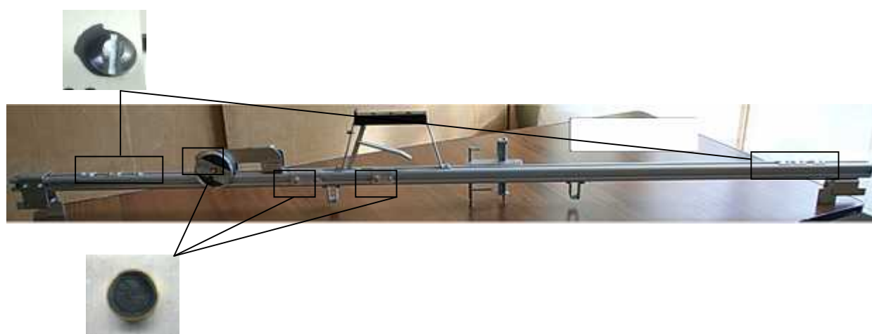
Рисунок 2 - Схема пломбировки от несанкционированного доступа
