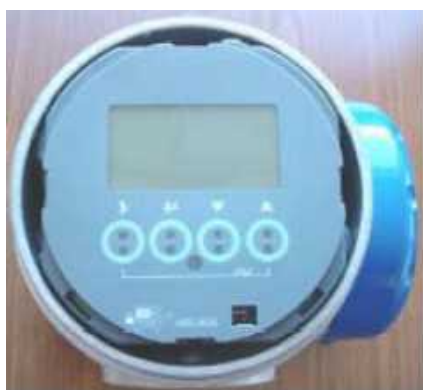
Рисунок 4 - Дисплей преобразователя сигналов IFC300 C/F. Защита от несанкционированного доступа
