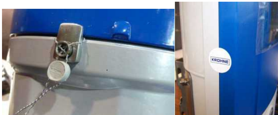
а) б) Рисунок 5 - Защита преобразователей сигналов IFC300 C/F/W и клеммной коробки ППР от вскрытия
