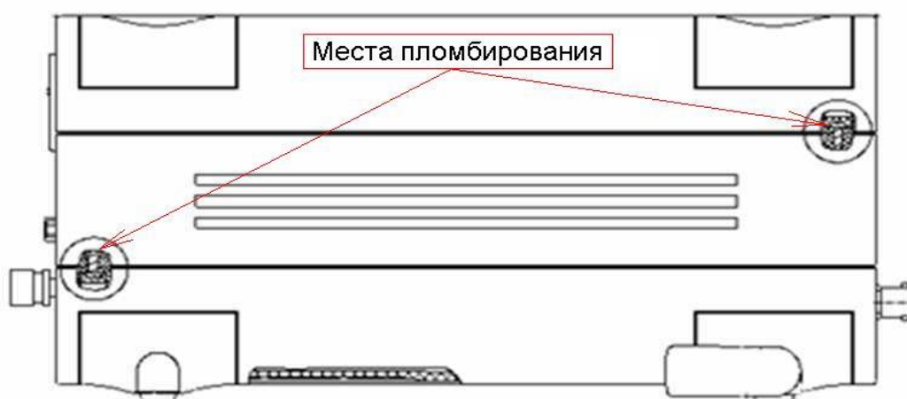
Рисунок 3 - Места для пломбирования измерителей разности фаз Ф2-41 (вид сбоку)
