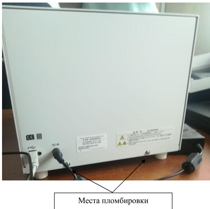
Рисунок 2 - Схема пломбировки от несанкционированного доступа
