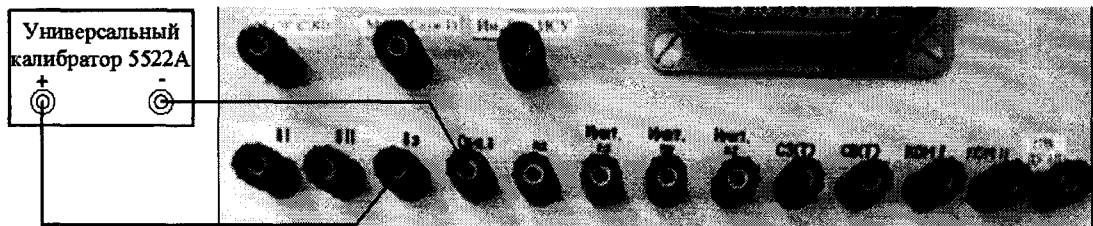
Рисунок 167 – Схема подключения для проверки напряжения по цепи «δэ»
