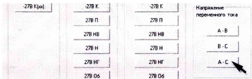
Рисунок 182 – Измерение напряжения переменного тока между фазами «А» и «С»
