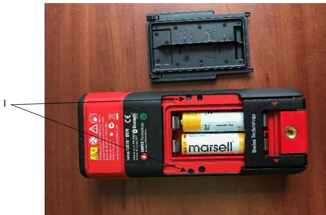
Рисунок 2 - Схема пломбирования дальномера лазерного Leica DISTO D510
