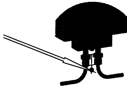
Рисунок 2 - Схема пломбировки от несанкционированного доступа крышки ЭЦБ «Шельф», обозначение места нанесения знака поверки
