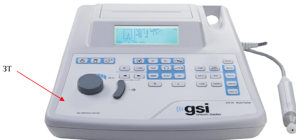
Рисунок 1 - Общий вид импедансометра. Лицевая панель
