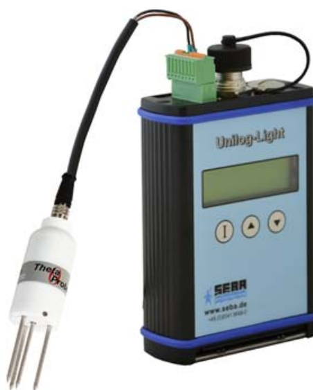
Рисунок 1 - Общий вид влагомера почвы высокой точности ML3 ThetaProbe
