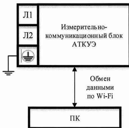
Рисунок 4 – Структурная схема для подтверждения программного обеспечения АТКУЭ
