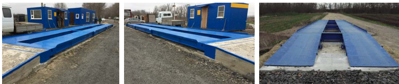
а) весы автомобильные Витязь-ВР
