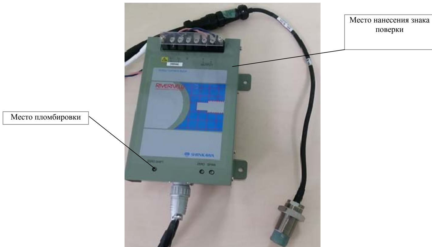
Рисунок 2 - Схема пломбировки от несанкционированного доступа и место нанесения знака поверки
