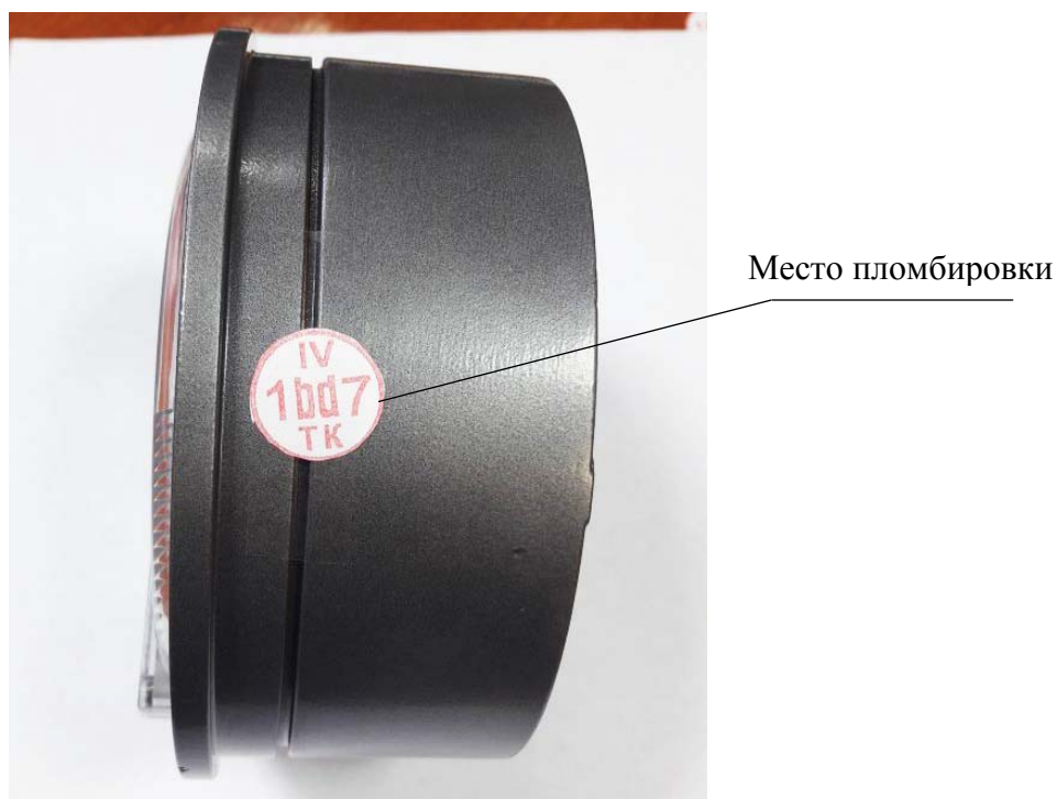
Рисунок 3 - Схема пломбировки манометров
