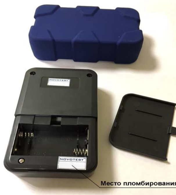
Рисунок 4 - Место пломбирования корпуса измерителей прочности строительных материалов NOVOTEST ИПСМ-М
