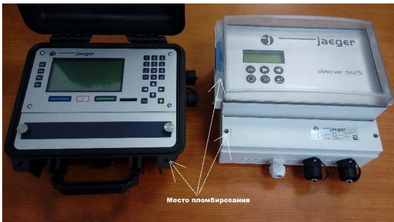
Рисунок 1 - Общий вид электронного блока fm3 и fm-s/fm2s и места пломбирования
