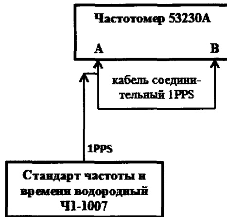
Рисунок 2 – Схема измерений временной задержки ВЧ-кабеля «1PPS»
