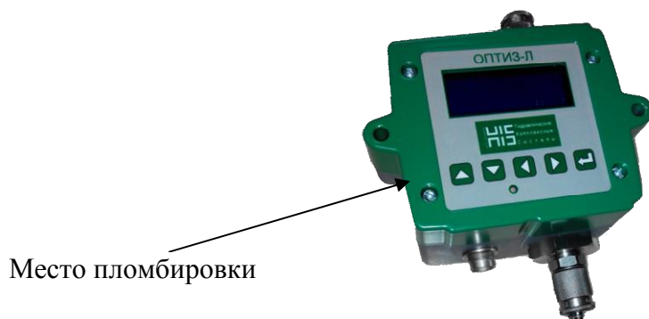
Рисунок 1 - Внешний вид счетчика частиц в жидкости ОПТИЗ-Л-01
