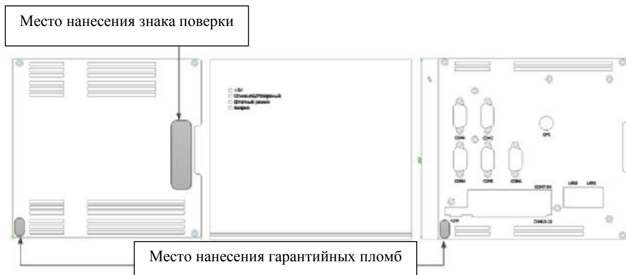
Рисунок 2 – Вид контроллеров с указанием мест пломбирования от несанкционированного доступа и нанесения знака поверки
