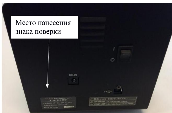
Рисунок 6 - Обозначение места нанесения знака поверки на приборы модели CA-2500
