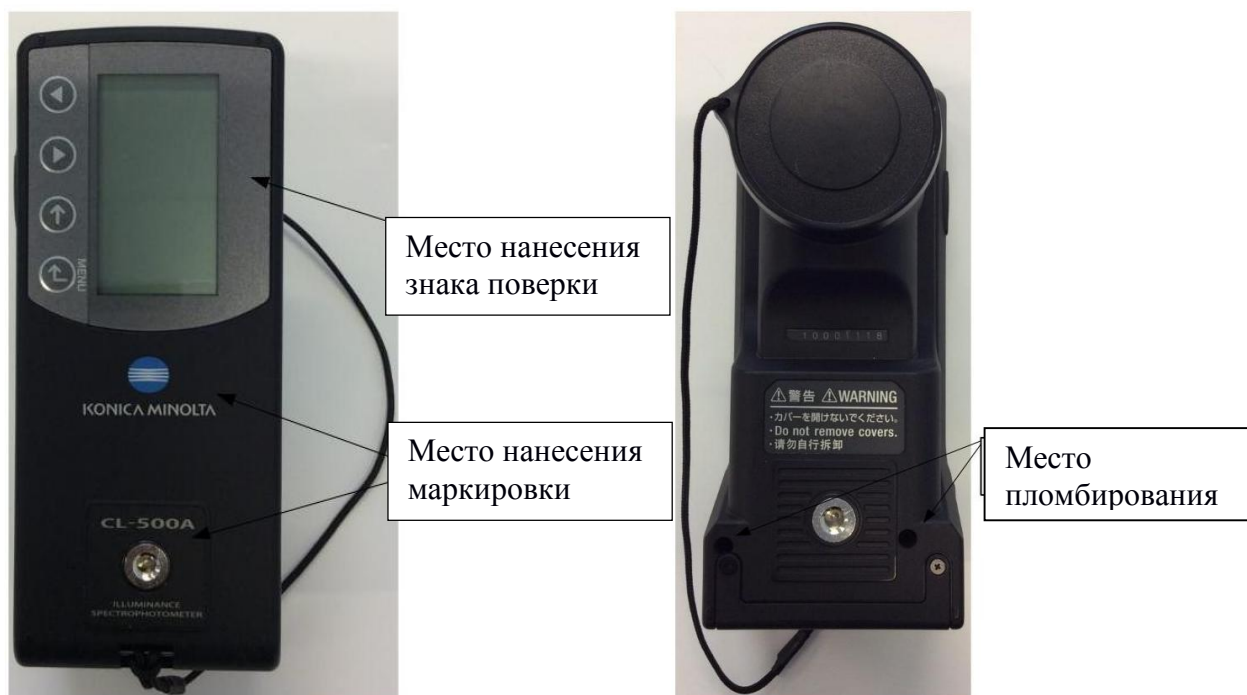
Рисунок 4 - Общий вид приборов модели CL-500A, схема пломбирования от несанкционированного доступа, обозначение места нанесения маркировки и знака поверки
