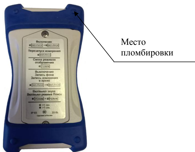
Рисунок 2 – Схема пломбировки от несанкционированного доступа
