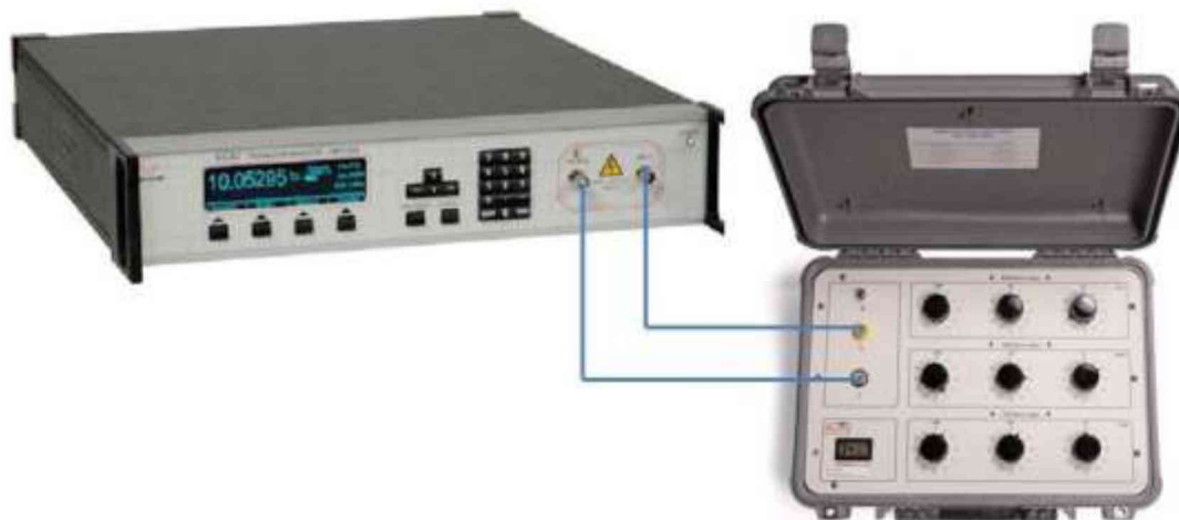
Рисунок 2 – Схема соединения меры АКПП-7516 и тераомметра 6530 при определении воспроизведения сопротивления постоянному току
