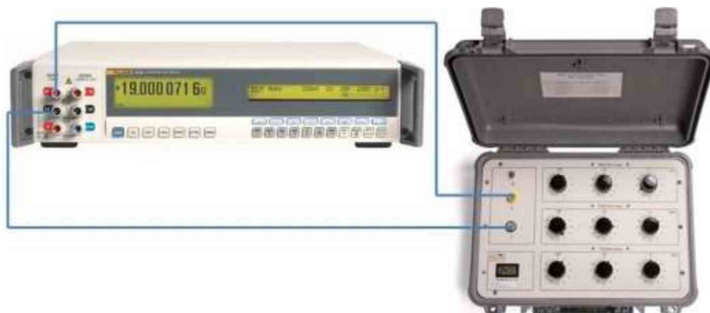
Рисунок 1 – Схема соединения меры АКПП-7516 и мультиметра 8508А при определении воспроизведения сопротивления постоянному току
