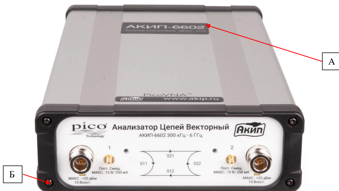
Рисунок 1 – Общий вид анализаторов, места нанесения знака утверждения типа (А) и пломбировки от несанкционированного доступа (Б)
