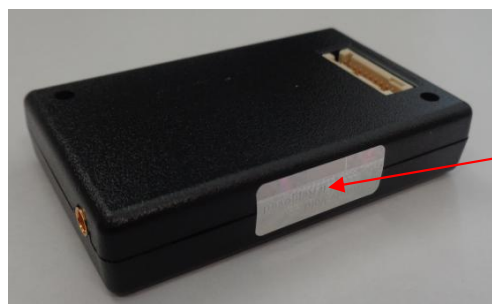
Рисунок 3 - Место пломбировки от несанкционированного доступа (вариант пломбировки № 2)
