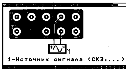
Рисунок 2.8.5.2 – Окно «Схема подключения прибора при снятии осциллограмм»
