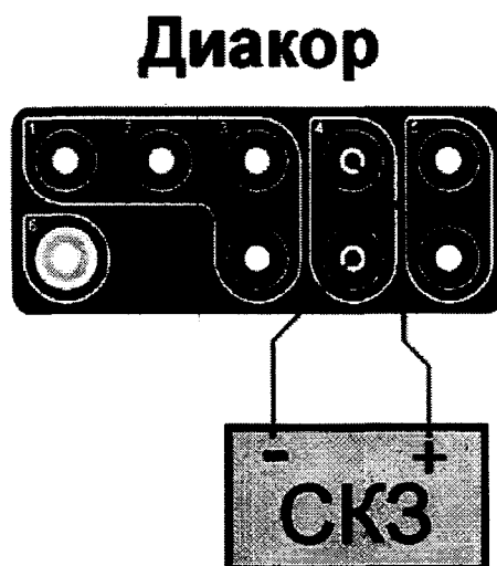
Рисунок 2.13.8.1 - Схема установки прибора на СКЗ
