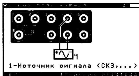
Рисунок 2.8.4.1 – Окно «Схема подключения прибора при проведении измерений»
