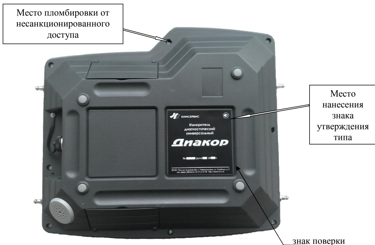
Рисунок 2 – Схема пломбировки от несанкционированного доступа, места нанесения знаков утверждения типа и поверки
