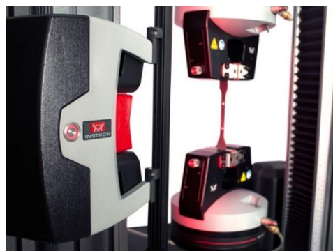
Рисунок 2 – Рабочая зона датчиков перемещений (деформаций) оптических бесконтактных серии 2663
