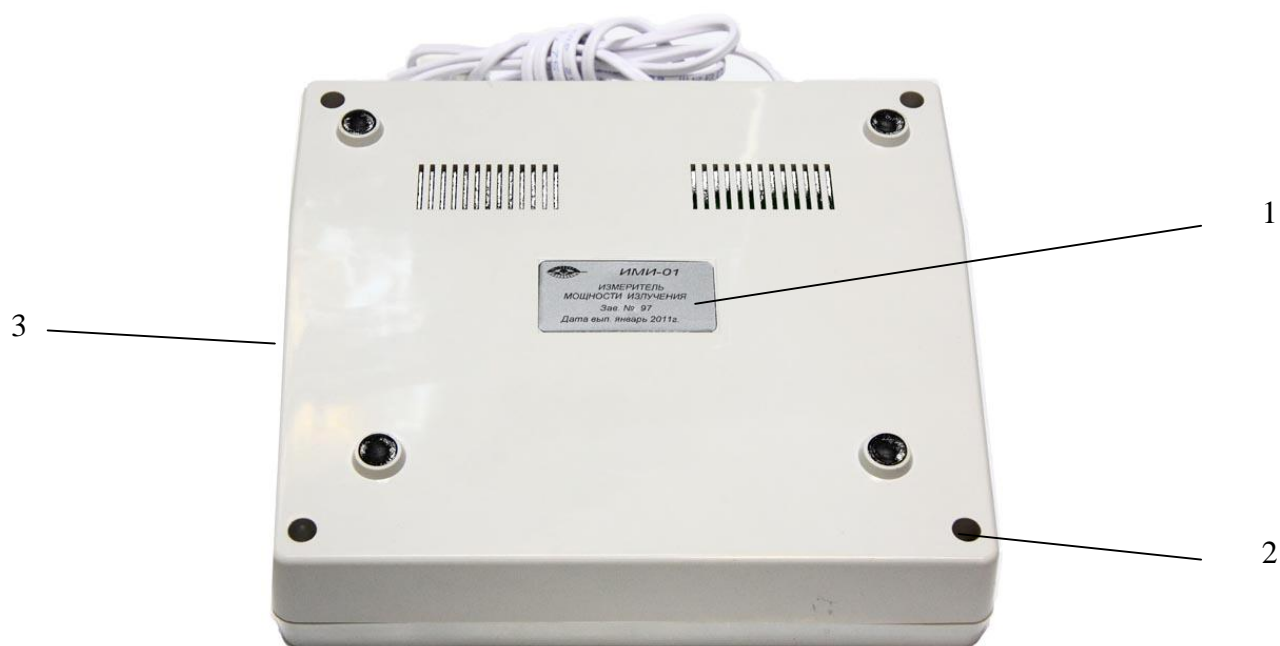
Рисунок 2 - Схема пломбирования, нанесения знака поверки и маркировки измерителя 1 - место нанесения маркировки; 2 – место установки пломбы; 3 – место нанесения знака поверки
