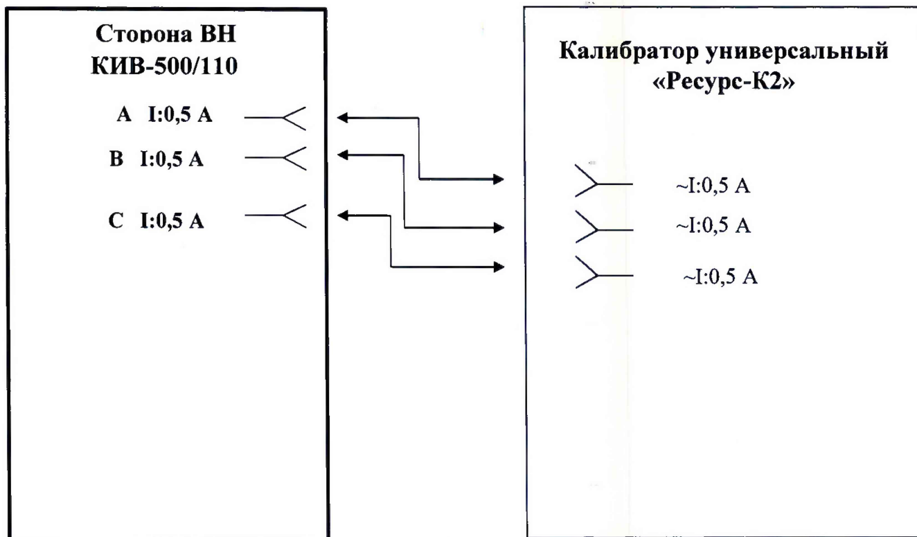
Рисунок А1 - Схема подключения прибора измерительного КИВ-500/110 (по стороне ВН) к калибратору универсальному «Ресурс-К2» для определения допустимой относительной погрешности измерений силы переменного тока (тока утечки)
