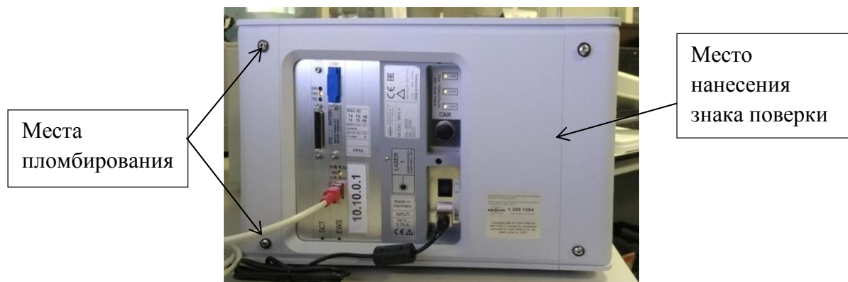
Рисунок 2 - Схема пломбировки от несанкционированного доступа и обозначение места нанесения знака поверки
