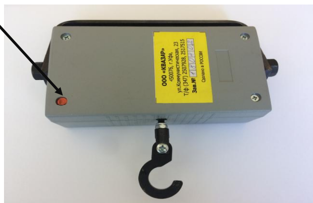
Рисунок 2 - Схема пломбировки от несанкционированного доступа
