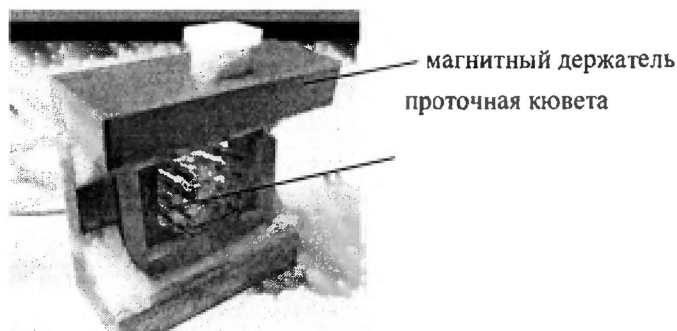
Рисунок 5 – Проточная кювета с трубками в магнитном держателе
