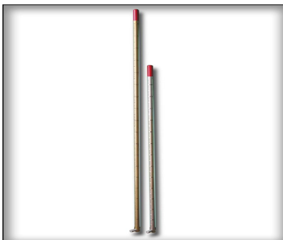
Рисунок 3 - Рейки РГ.ГМП.ГР-7М-I, РГ.ГМП.ГР-7М-II
