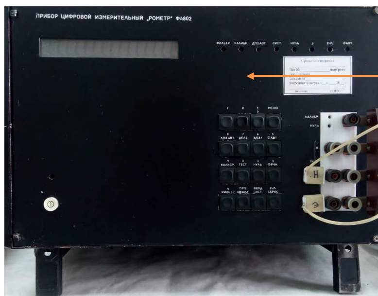
Рисунок 1 – Общий вид терминала, место нанесения знака поверки
